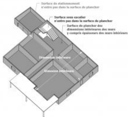
Surface de plancher du rez-de-chaussée
